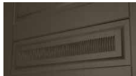
frézování povrchu v různých hloubkách
